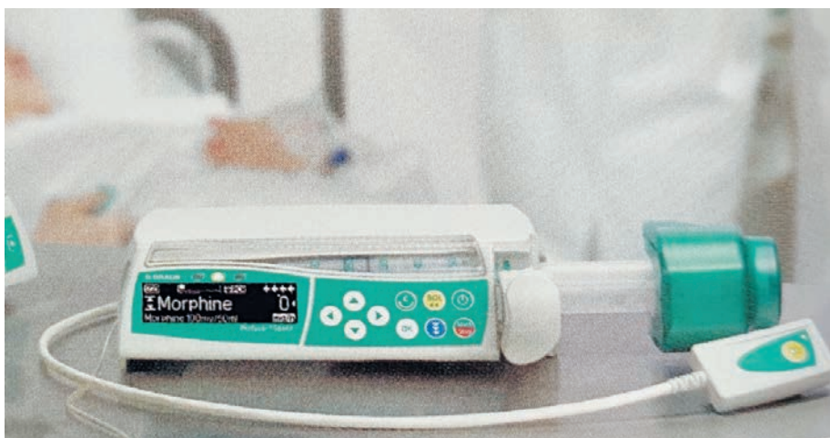
Рис. 19.1. Набор для проведения контролируемой пациентом аналгезии при помощи инфузионного насоса (в комплекте: болюсная кнопка с кабелем, кольцо и лента для крепления болюсной кнопки на кисти пациента, ключ для блокирования держателя шприца и фиксатора плунжера шприца)
